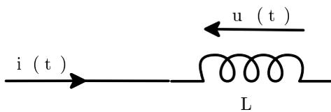
Par définition de l'intensité  $i(t)$ , on a  $u(t) = L \frac{di(t)}{dt}$ . Or  $i(t) = I\sqrt{2} \sin(\omega t + \varphi)$ , donc
